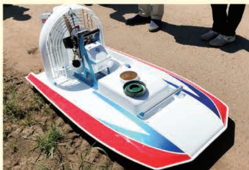
写真② 除草剤散布ボート(YF260) (写真提供: JA全農ちば)
